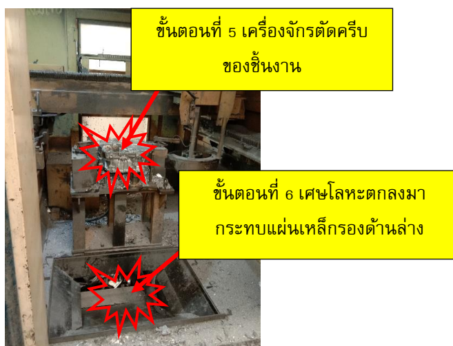
รูปภาพที่ 1.2 ขั้นตอนที่ 5 และ 6 ที่ก่อให้เกิดเสียงดัง
