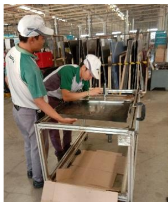
รูปภาพที่ 4.1-4.3 จัดทำแผ่นรองรับเศษโลหะพร้อมกับแผนก Kaizen
