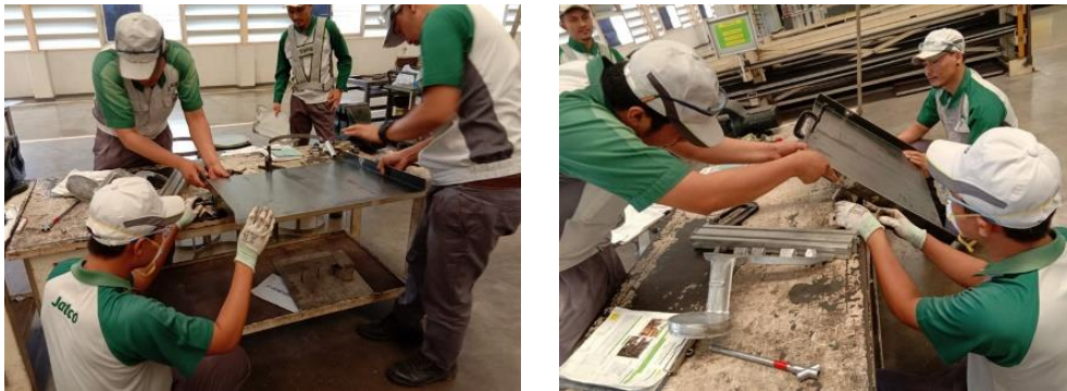
พนักงานแผนก Kaizen ปรับขนาดแผ่นเหล็กให้ได้ตามที่ออกแบบไว้
