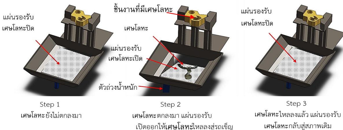
รูปภาพที่ 2.2 ภาพวาดแสดงกลไกการทำงาน หลังการปรับปรุง
